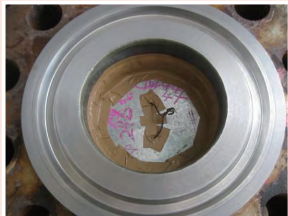
リングジョイント V 溝加工
