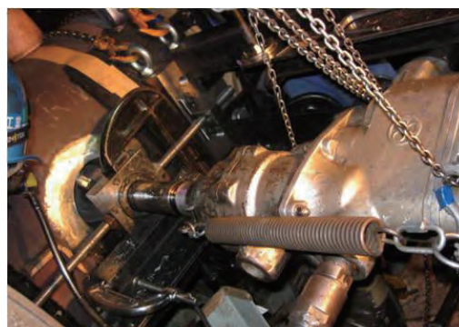
特殊治具を使用したサンプリングノズル部の座繰り
